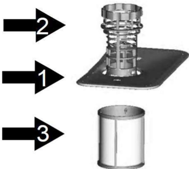
Система фильтрации состоит из трех компонентов: плоского (основного) фильтра, грубого фильтра и микрофильтра (тонкого фильтра).
