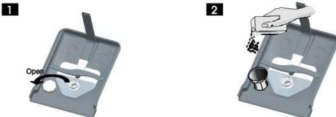
**A** Снимите нижнюю корзину, затем выкрутите и снимите крышку контейнера для соли. **1**
